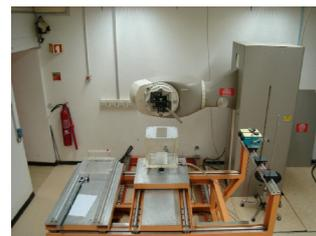
Figura: Setup utilizado em calibrações para radioterapia no LMRI (Laboratório de Metrologia das Radiações Ionizantes)
